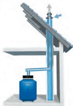
Raumluftunabhängige Aufstellvariante mit eingezogener Kunststoff-Abgasleitung im Kamin.
