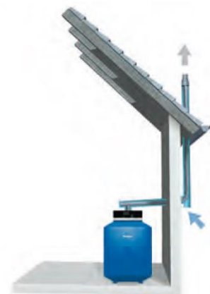
Raumluftunabhängige Aufstellvariante mit Rohr-in-Rohr-Kunststoff-Abgassystem entlang der Außenfassade.
