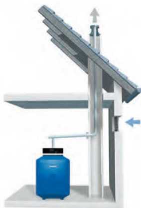
Raumluftabhängige Aufstellvariante mit eingezogenem Abgasrohr im Kamin.
